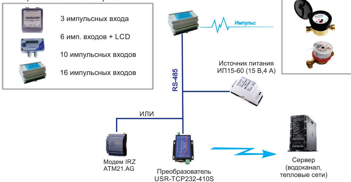
**Схема дистанционного съема показаний Пульсар с цифровым выходом RS-485 для многоквартирных домов**
